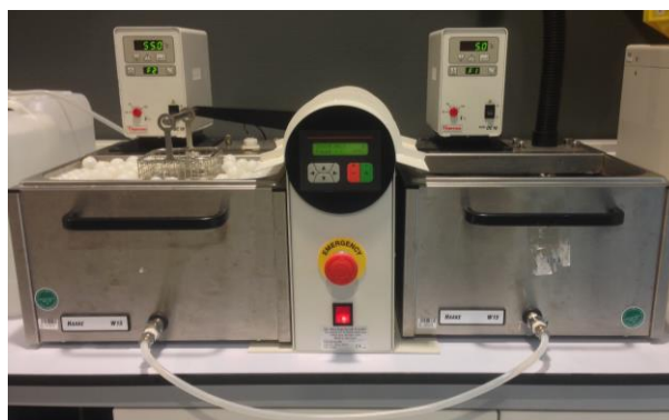
Figuur 11. Machine t.b.v. de thermocycling met links het bad van 55 °C en rechts het bad van 5 °C.
